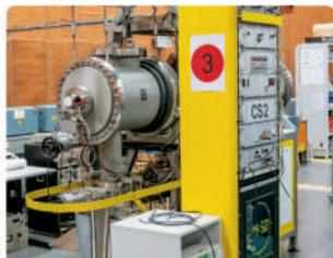
El reloj at6mico, un dispositivo que mide el tiempo con gran precisi6n —su error es de un segundo en 300 000 a6os—, emplea la frecuencia de vibraci6n at6mica del is6topo 133 del **cesio**.
