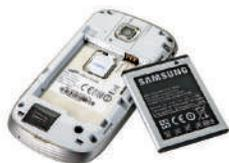
La batería de ion **litio** se caracteriza por su poco peso en relación con la energía que suministra. Además, se puede cargar y descargar un elevado número de veces sin perder mucha capacidad. Por ello, actualmente se usa como batería en dispositivos móviles, agendas electrónicas, ordenadores portátiles y reproductores de música.
